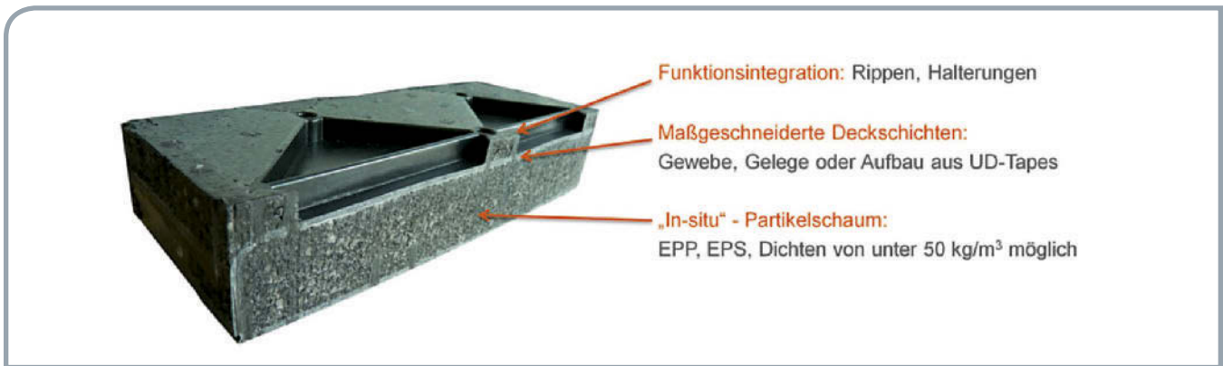
In-situ-Partikelschaumkern im Verbund mit maßgeschneiderten Thermoplast-Deckschichten.
